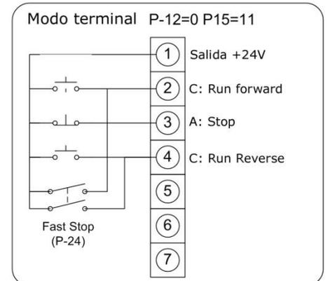
Pulsadores fwd/rev/stop con parada rápida usando la segunda rampa de deceleración
