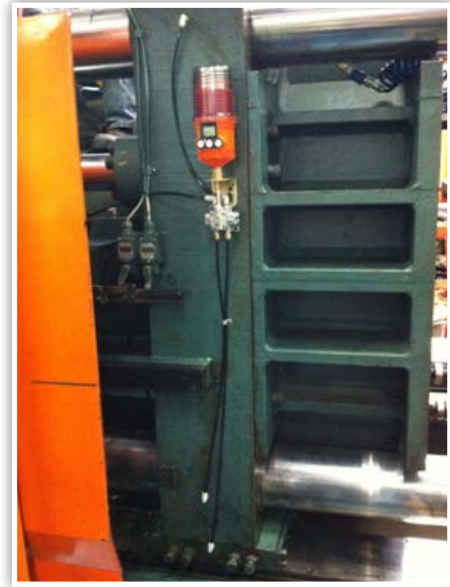
El Streamliner M también se puede utilizar para lubricar puntos múltiples con el uso de un bloque de distribución progresivo. Para más información, favor de ponerse en contacto con su surtidor local o fabricante.
