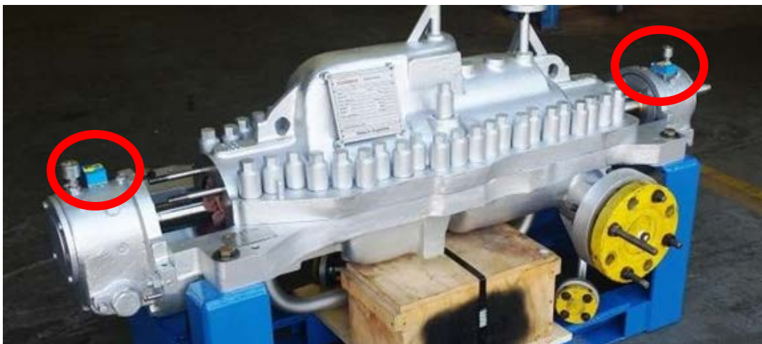
Figura 17: Bomba entre rodamientos (BB3), instalación en ambas cajas de rodamiento
